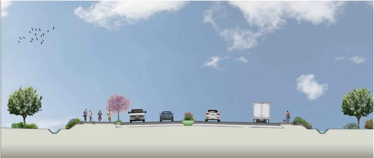
Sezione prospettica in corrispondenza della circonvallazione di Alghero. Sezione stradale Tipo D integrata con pista ciclopeditonale
